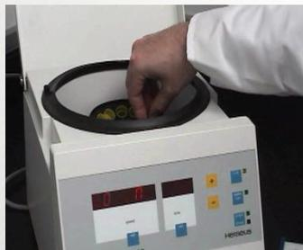
Descarte el sobrenadante, Limpie y remueva el círculo de grasa dentro del tubo con hisopos. Asegúrese de no tocar el precipitado.
