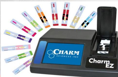
El sistema Charm EZ (incubadora y lector en uno) hace un rápido trabajo de análisis de antibióticos y aflatoxina M1 en la leche. Simplemente inserte una tira de flujo lateral ROSA (Rapid One Step Assay) y agregue leche. El sistema Charm EZ identifica automáticamente la prueba, el tiempo de incubación y la temperatura. Cierre la puerta y los resultados estarán listos en minutos
