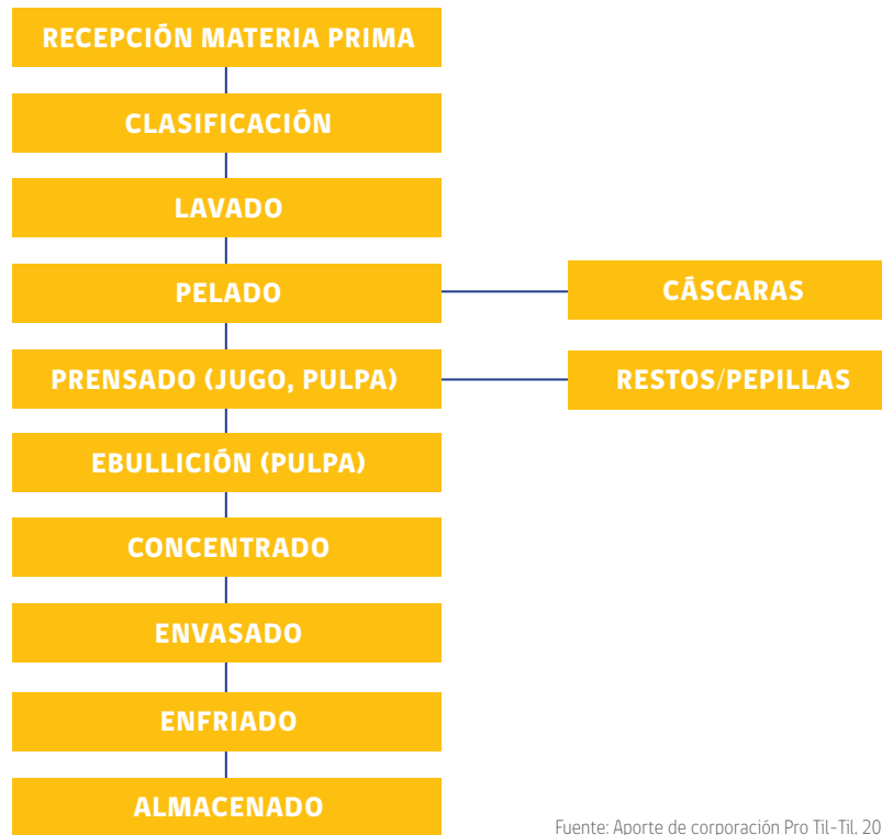
Figura 11. Diagrama de flujo de la elaboración de mermeladas.
